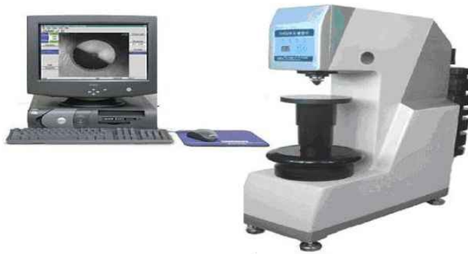
Hình 1.1- Máy kiểm tra độ cứng Brinell.
