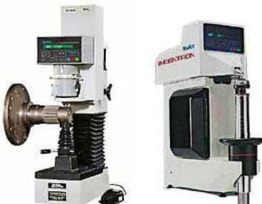
Hình 1.8- Thiết bị đo độ cứng Rockwell
