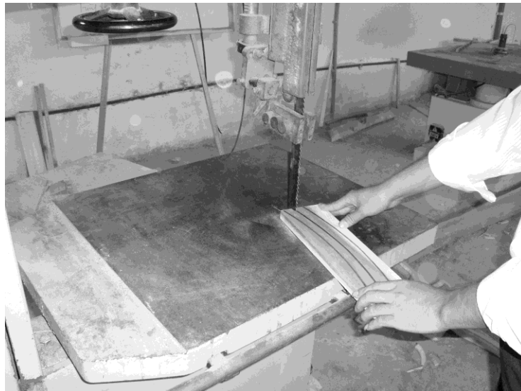
Xẻ phôi cong bằng máy cưa vòng mộc
