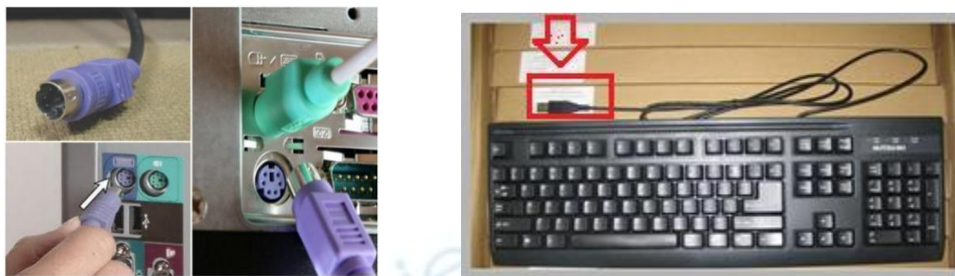
Hình 1.1: Bàn phím kết nối cổng PS2 và USB
