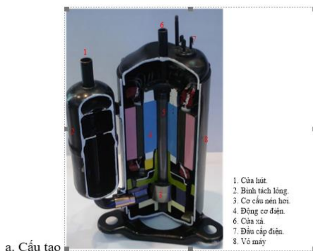
Hình 1.5- Block máy nén rô to lăn
