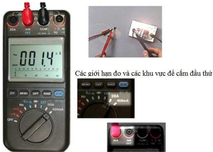
Hình 1.8: Đo cường độ dòng điện một chiều
