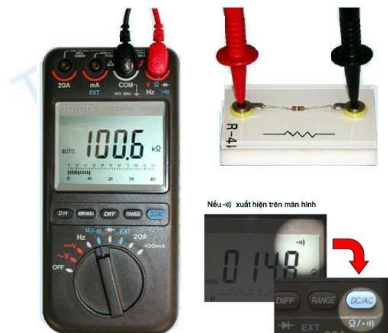
Hình 1.3: Đo điện trở
