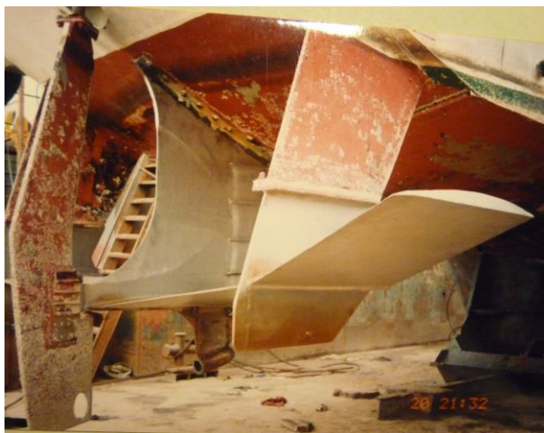
Hệ thống cánh ngầm lái của tàu cánh ngầm VOKHOD - 2M
