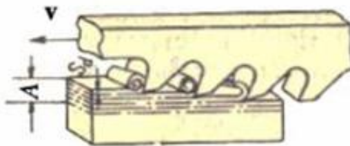
Hình 5-53 Sơ đồ chuốt mặt phẳng
