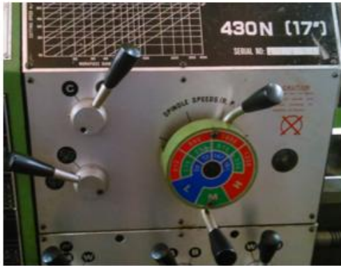
Hình 3.16 – Điều chỉnh tốc độ trục chính, lượng chạy dao
