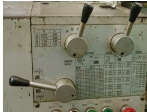
Hình 3.16 – Điều chỉnh tốc độ trục chính, lượng chạy dao
