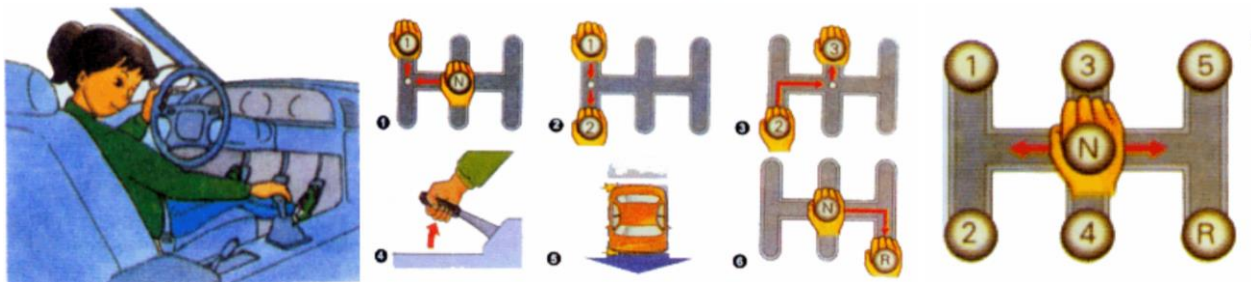
Hình 12: Phương pháp điều khiển cần số cơ khí
