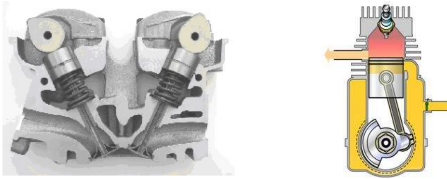
Hình 1.2: Hệ thống phân phối khí loại trực cam đặt trên nắp máy (a) và loại ngấn kéo phân phối (b)
