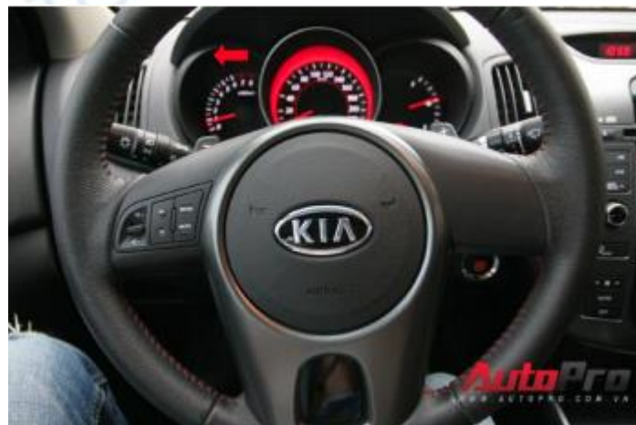
Hình 3.5. Điều khiển đèn xin đường
