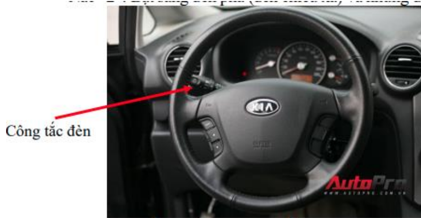
Hình 3.4. Điều khiển đèn pha, cốt và các loại đèn chiếu sáng khác
