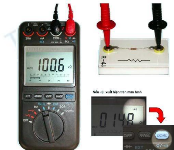
Hình 1.3: Đo điện trở
