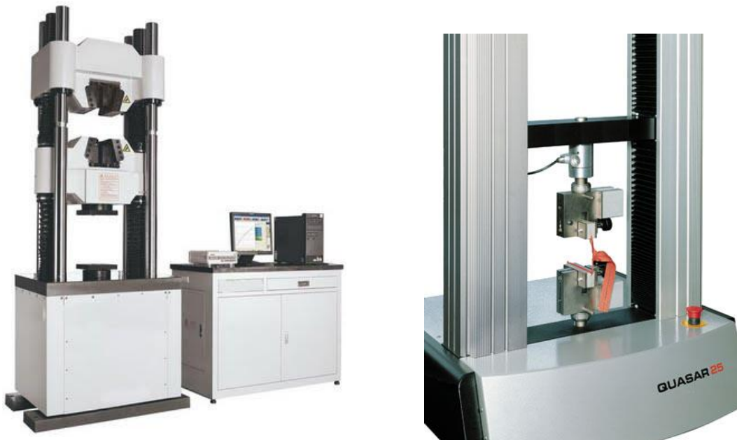
Hình 21.1 Máy thử kéo nén dùng tenzo cầu điện trở điều khiển bằng máy tính
