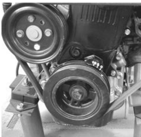
Hình - Thời điểm đánh lửa muộn
