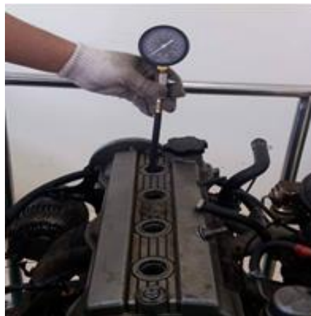
Hình 1.1 Kết nối áp kế vào lỗ buzi
