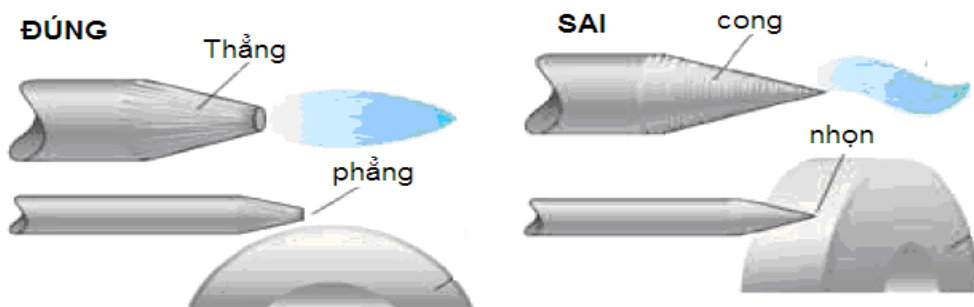
Hình 1.5 Hình dạng và cách mài điện cực
