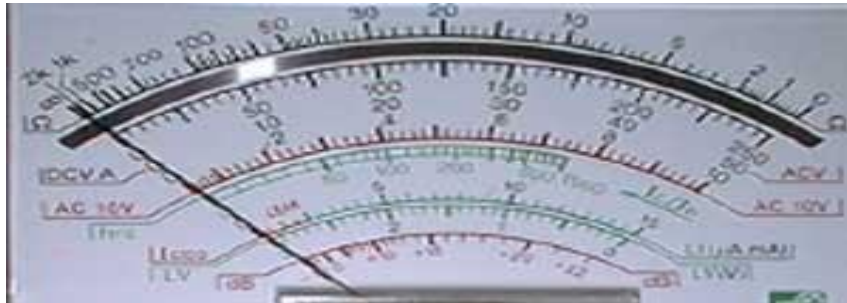
Hình 1.13: Cách đọc giá trị dòng điện và điện áp trên VOM
