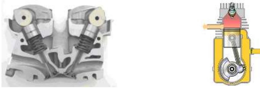
Hình 1.2: Hệ thống phân phối khí loại trực cam đặt trên nắp máy (a) và loại ngăn kéo phân phối (b)
