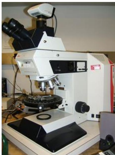
Hình 1. 2. Kính hiển vi phân tích thành phần thạch học
