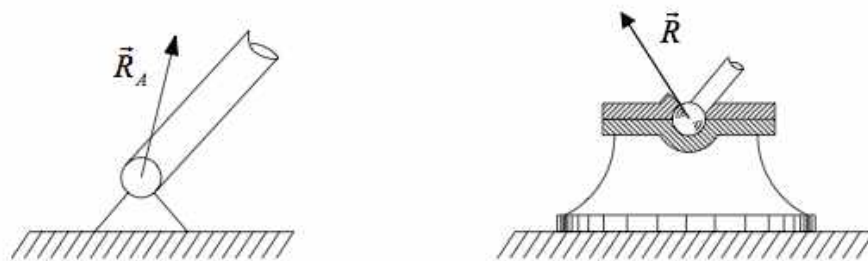
Hình 1.10. Liên kết bản lề trụ và bản lề cầu
