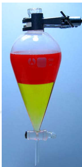
Hình 1.7. Sự phân lớp trong chiết lỏng-lỏng
