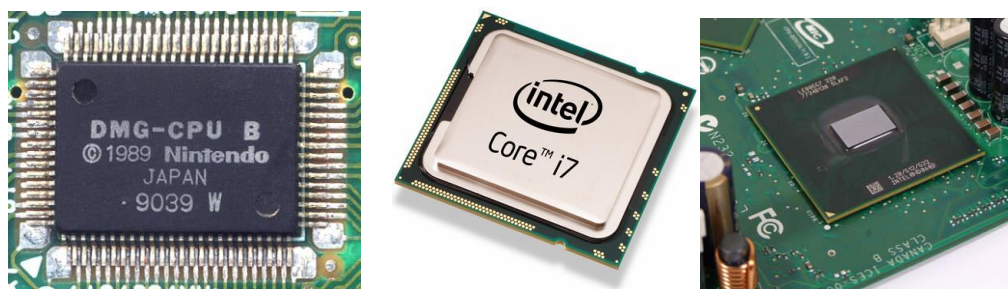
Hình 1. 2. Mặt dưới, mặt trên bộ xử lý trung tâm, bộ xử lý trung tâm tích hợp
