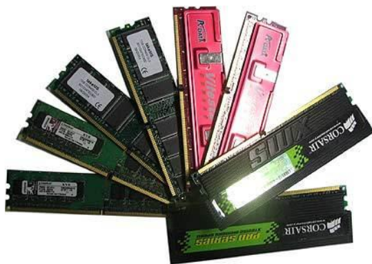
Hình: Bộ nhớ RAM và khe cắm bộ nhớ RAM trên bo mạch chính (Mainboard)
