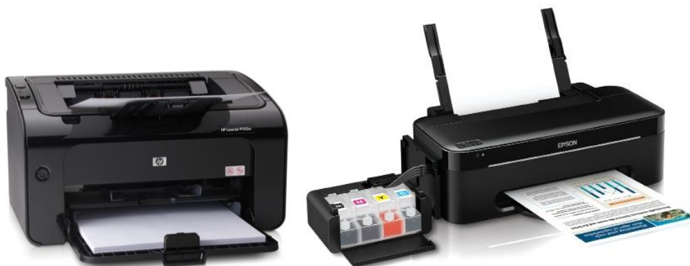
Hình: Máy in Laser và máy in phun
