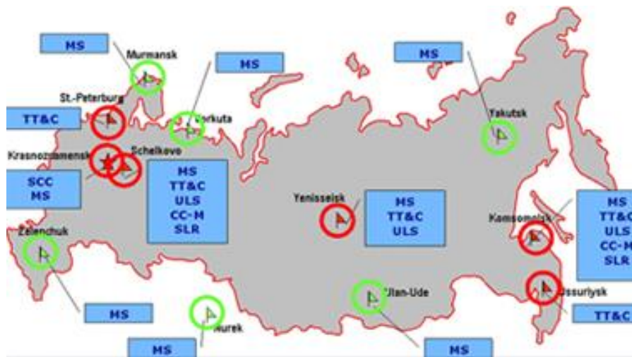
Hình 3.3. Đoạn điều khiển của hệ thống GLONASS
