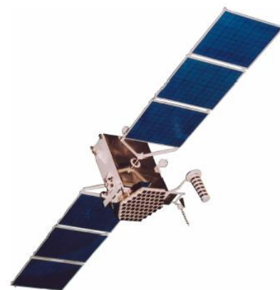
Hình 3.2. Vệ tinh GLONASS-K
