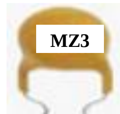
Hình 12: Hình dáng của NTC và PTC.
