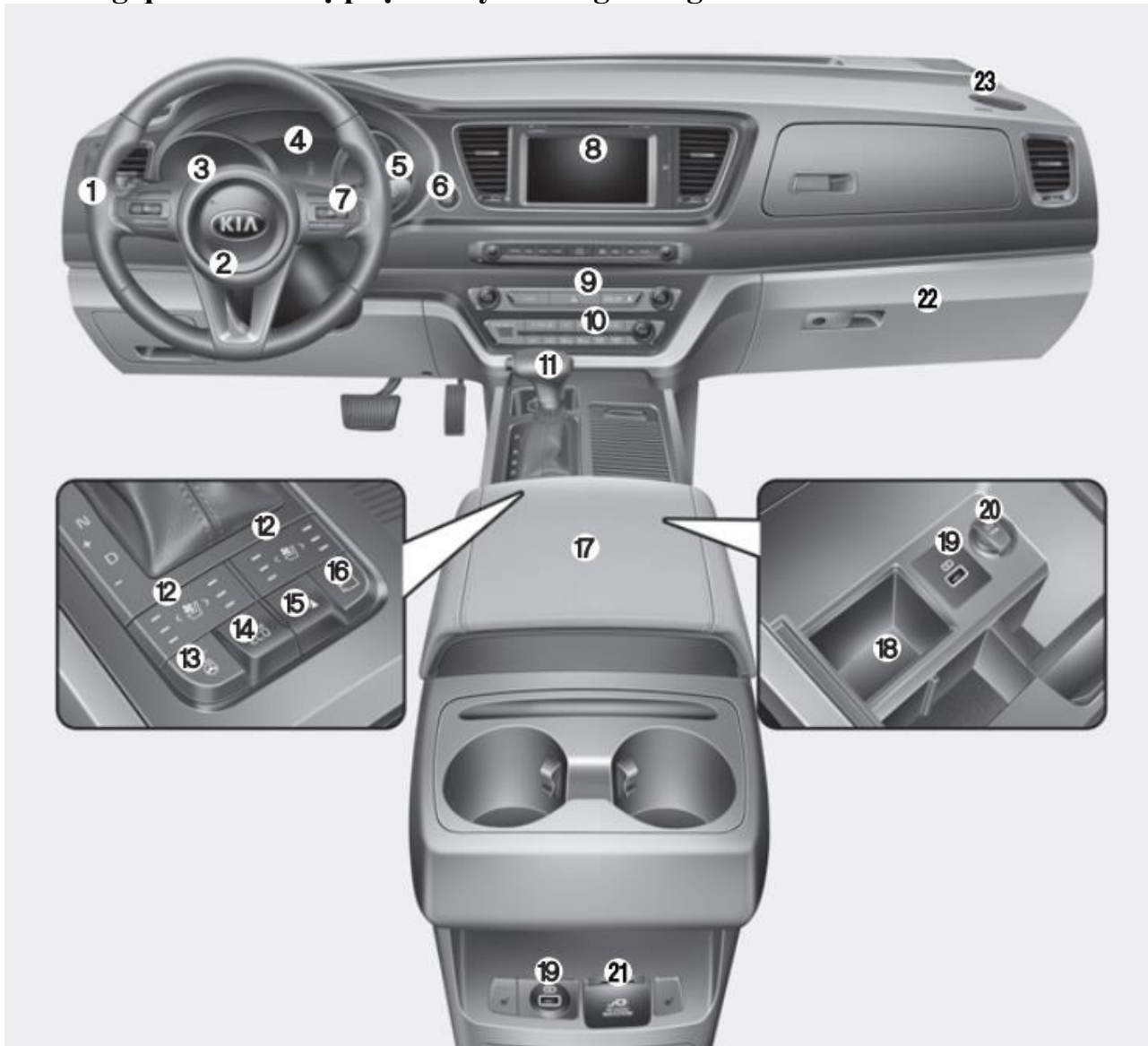
Hình 2.1. Các bộ phận chủ yếu trong buồng lái ô tô số tự động
