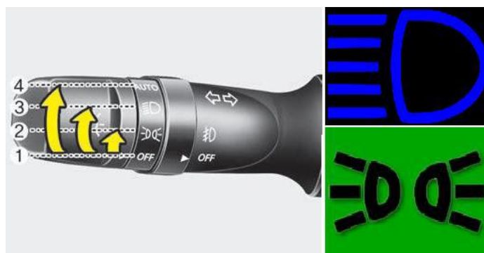
Hình 2.5. Đèn đèn chiếu xa, đèn chiếu gần và các loại đèn chiếu sáng khác
