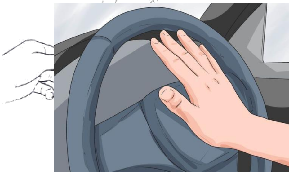
Hình 2.4. Vị trí công tắc còi điện
