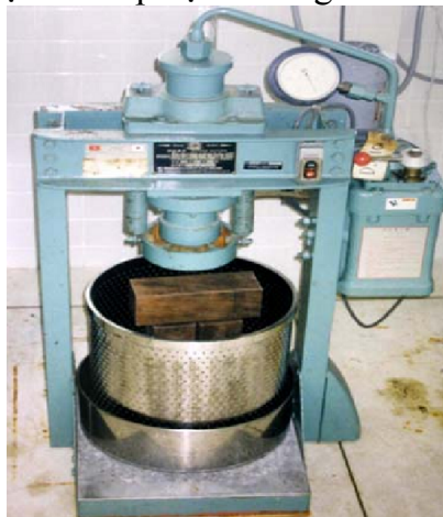
Hình 1.16. Máy ép thủy lực (Lê Mỹ Hồng, 2005)
