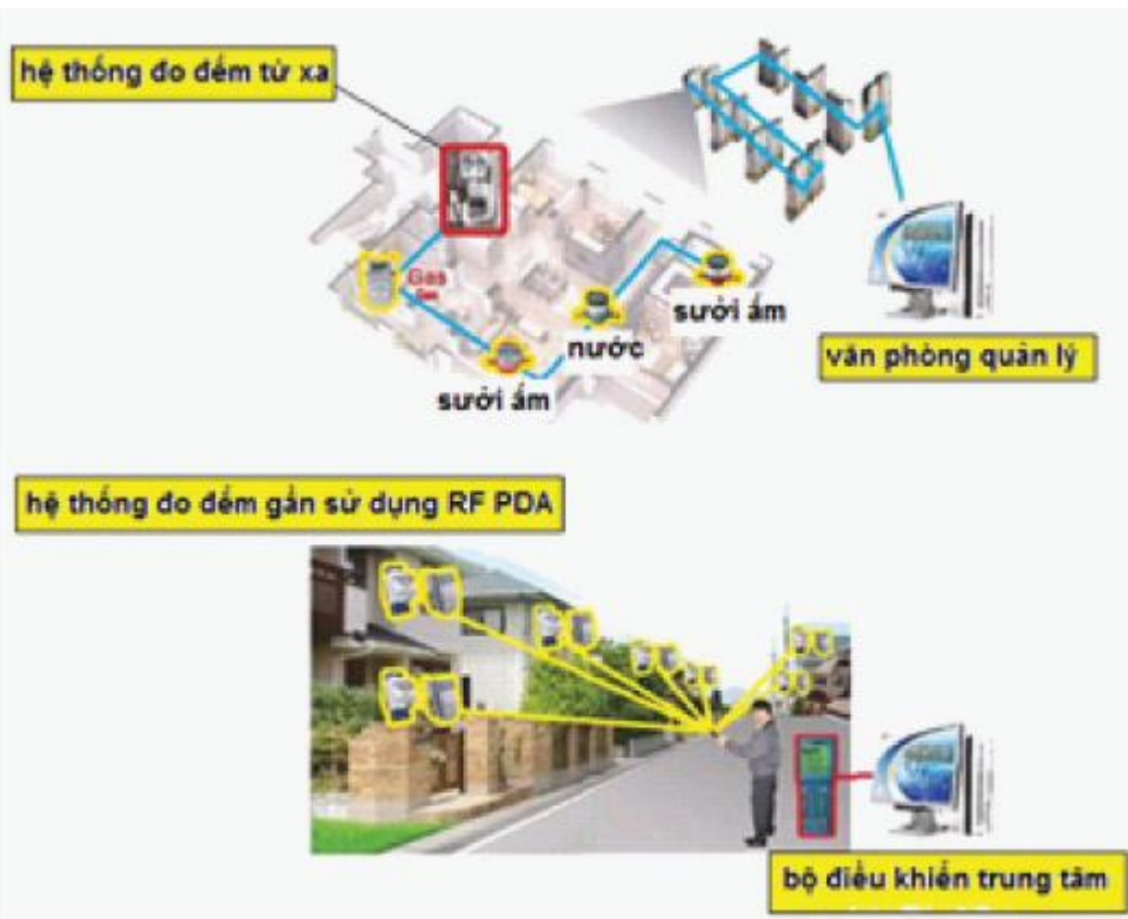
Hệ thống đo đếm từ xa
