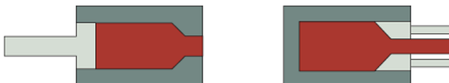
Hình 3.10 Gia công đùn ép
