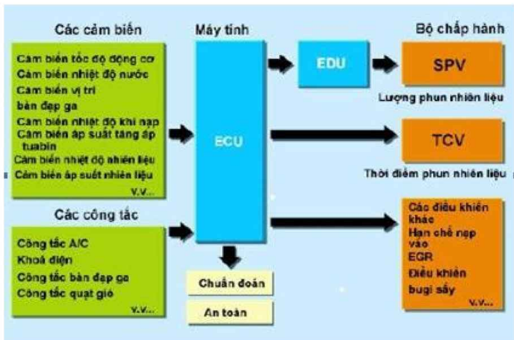
Hình 1. Sơ đồ hệ thống điều khiển điện tử EFI- Diesel với bơm cao áp
