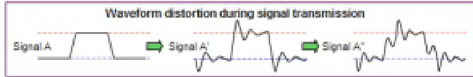
Hình 1.8. Nhiễu làm biến dạng tín hiệu
