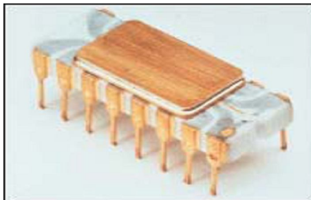
CPU đầu tiên do Intel sản xuất năm 1971 có tốc độ 0,1MHz
