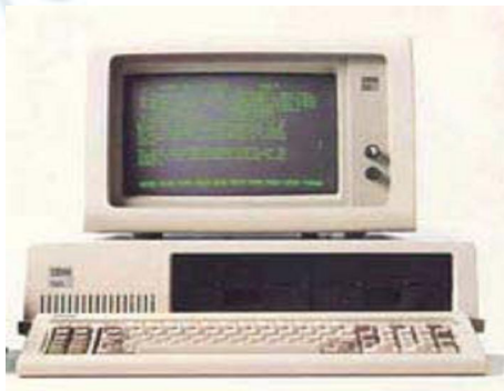
Máy tính PC của hãng IBM sản xuất năm 1981 thuê công ty Microsoft viết hệ điều hành MS - DOS Chiếc máy này có tốc độ 5MHz
