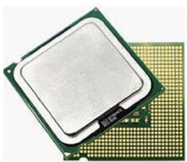
CPU Pentium 4 sản xuất năm 2006 với tốc độ 3,2GHz tốc độ này nhanh gấp 32.000 lần tốc độ CPU ban đầu
