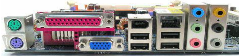
Card màn hình Onboard là cổng màu xanh đặc trưng
