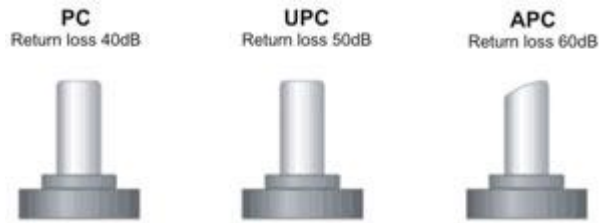
Hình 5.7c: Hình đầu nối cáp quang
