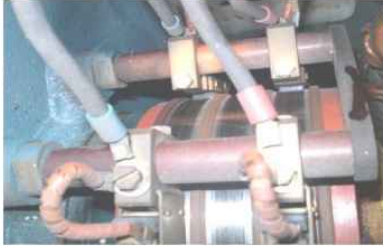
Hình 6.1: Vành trượt-chổi than ở máy công suất bé và công suất lớn
