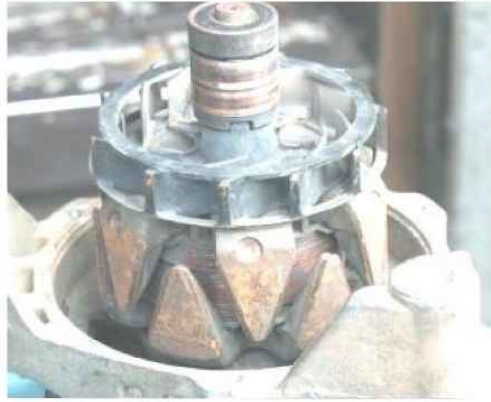
Hình 1.6: Phần cảm quay dùng thép ghép và thép khối
