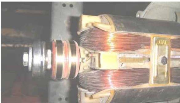
Hình 1.2: Rô to của máy phát có phần ứng quay và chổi than
