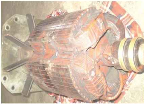
Hình 1.4: Phần cảm của máy phát có 2 đôi cực
