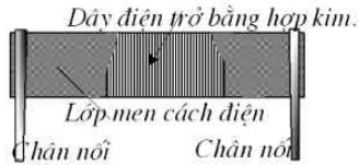
Hình 1-5: Điện trở dây quấn
