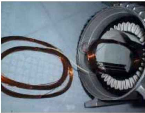
Hình 17.20: Dùng giấy cách điện lót cạnh dây chờ (cạnh dây chưa lồng vào rãnh)
