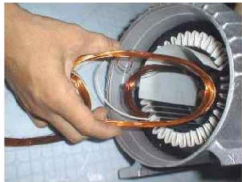
Hình 17.28: Quay 180° đưa bối dây vào trong lòng stato
