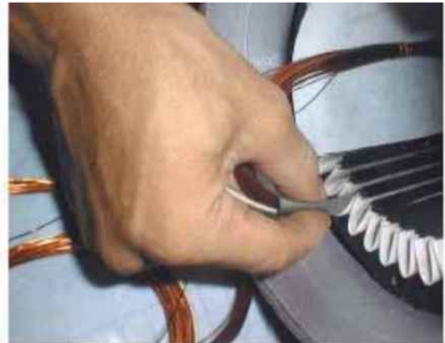
Hình 17.26: Đẩy từ từ giấy nêm vào rãnh
