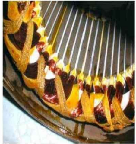
Hình 17.30: Cách điện giữa các nhóm bối dây, và đai đầu nối
