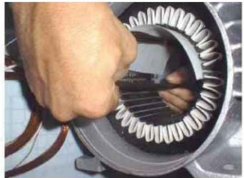
Hình 17.21: Căng cạnh tác dụng để giữ song song các vòng dây khi lồng dây
