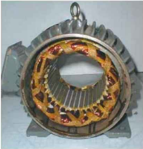
Hình 17.29: Dây quấn stato sau khi quấn hoàn chỉnh
