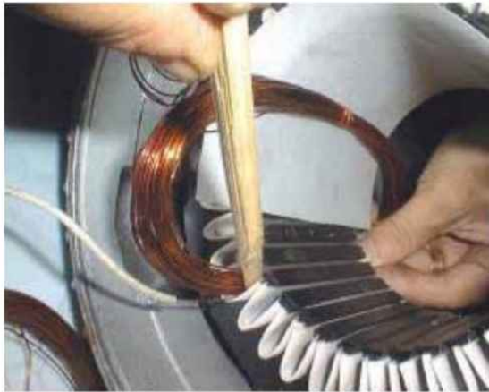
Hình 17.24: Thao tác kéo thẳng (không nhấn) cây miết để xếp dây song song
