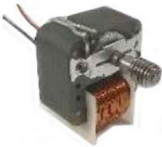
Hình 2.1: Cấu tạo động cơ xoay chiều KĐB có vòng chập
