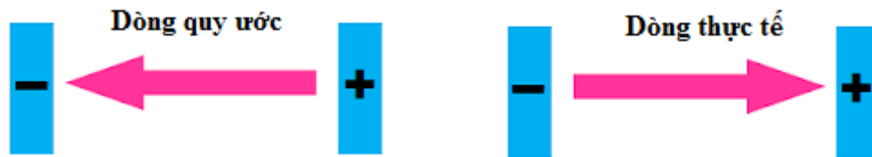
Hình 1.0-9: Chiều dòng điện thực tế và quy ước
