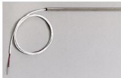
Mã số : PR-10 của hãng Omega Cấu hình 3 dây. Loại Wire wound Tầm hoạt động : -200 đến 600°C Dùng để đo nhiệt độ chất lỏng
