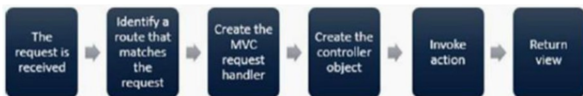
Hình 1.3. Quá trình xử lý yêu cầu của MVC
