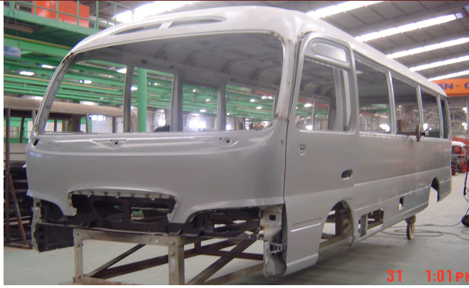
Hình 4.2. Sau công đoạn bọc nóc và bọc vỏ
