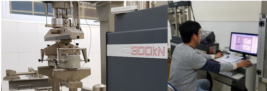
Hình 3.12. Thực hiện thí nghiệm uốn ba điểm mẫu đầm có rãnh
