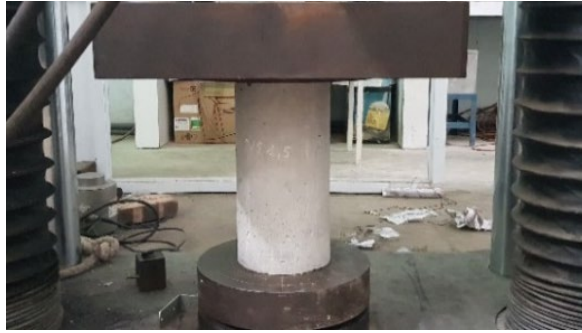
Hình 2.16. Thí nghiệm cường độ nén BTCĐC sử dụng NS
