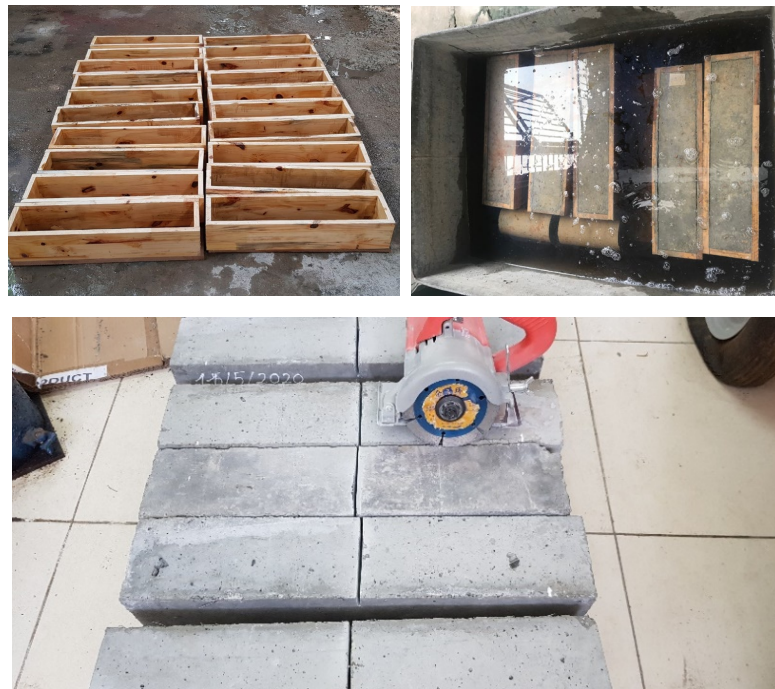
Hình 3.7. Chuẩn bị mẫu đầm thí nghiệm uốn ba điểm có rãnh mồi
