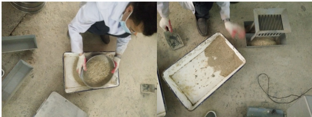
Hình 2.6. Thí nghiệm thành phần hạt cát
