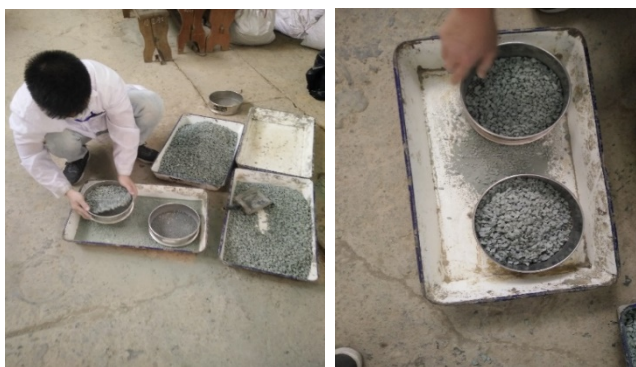
Hình 2.4. Sàng và phối trộn thành phần hạt đá theo tiêu chuẩn ASTM C33
