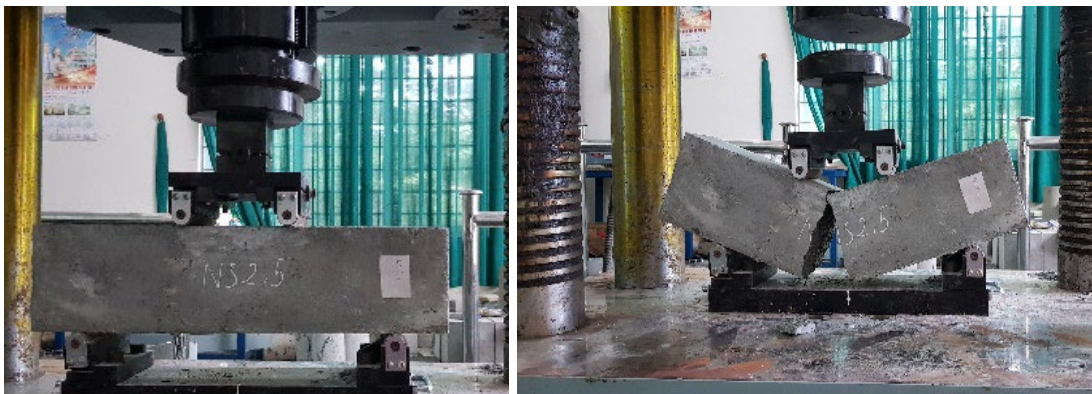
Hình 2.20. Thí nghiệm cường độ kéo khi uốn BTCĐC sử dụng NS
