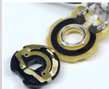
Cấu tạo trong triết áp
