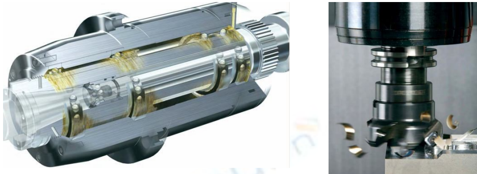
Hình 1.2: Cụm trục chính máy
