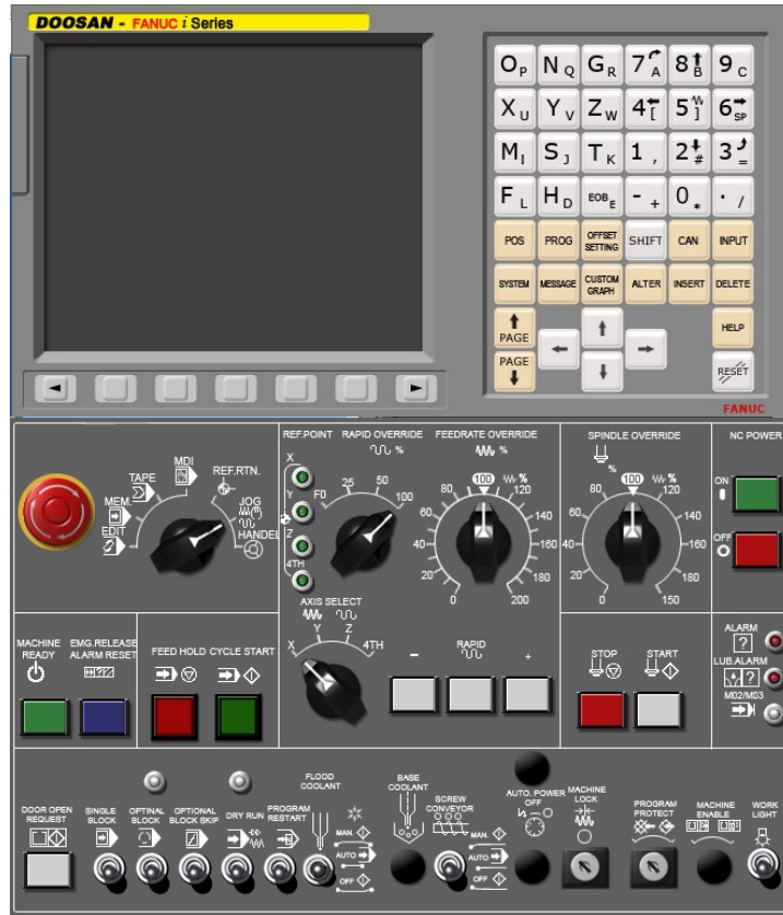
Hình 1.7: Bảng điều khiển máy phay cnc
