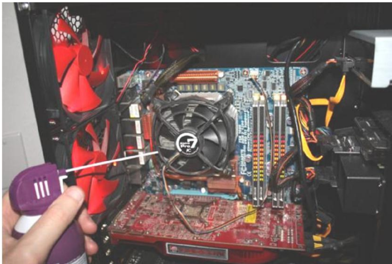
Hình 1.7: Vệ sinh quạt CPU và quạt VGA
