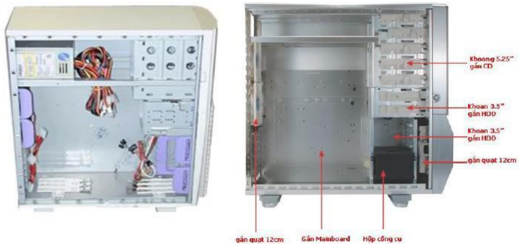
Hình 2.1.1. Cấu trúc bên trong của thùng máy Dây tín hiệu
