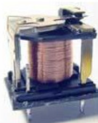
Hình 1.26: Hình dạng của một loại Rơ le
