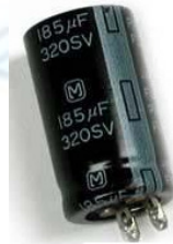
Hình 1.20: Tụ hoá ghi điện dung là 185 µF / 320 V
