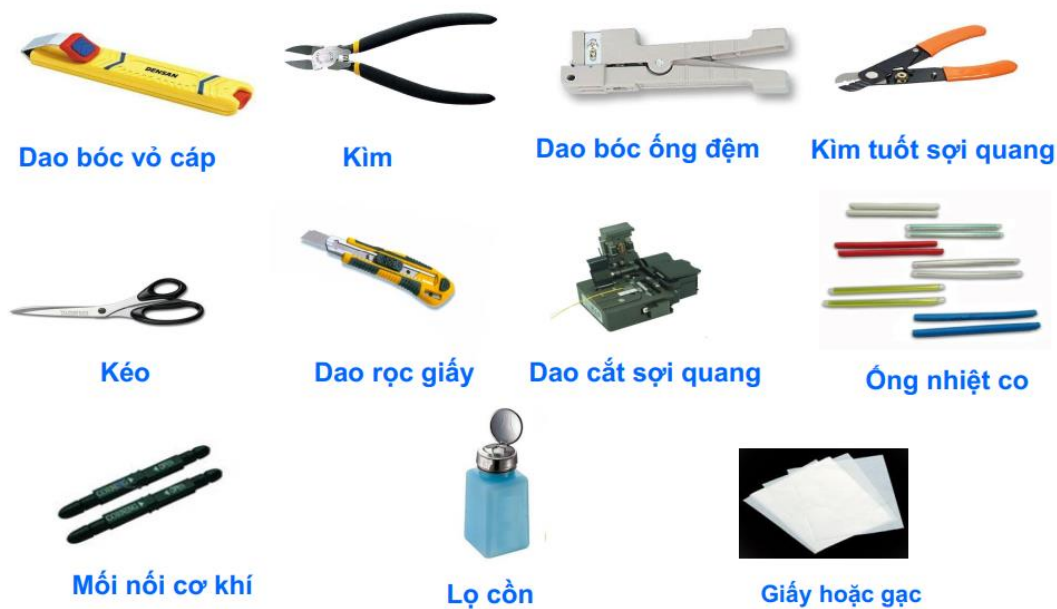
Hình 2.2. Dụng cụ, vật tư hàn nối sợi quang
