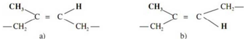
Hình 2.4. Các dạng đồng phân hình học của izopren: a. cấu trúc cis (cao su tự nhiên), b. cấu trúc trans (gutta percha).
